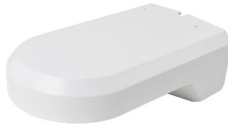
Ce support permet de fixer la caméra Vision 360° contre un mur à la verticale. Conçu en polycarbonate, il bénéficie d'une très grande résistance aux contraintes thermiques et mécaniques. Peut s'installer en intérieur ou en extérieur. L'intérieur du support permet de faire passer les câbles RJ45 et d'alimentation électrique.
