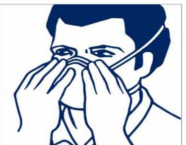
6. L'étanchéité au visage du masque devra être vérifiée avant d'entrer dans l'atmosphère polluée. Pour vérifier l'étanchéité au visage, placer les deux mains en coquille sur le masque et expirer très fortement. Si vous détectez une fuite d'air, ajuster la position du masque sur la figure et/ou la tension des élastiques.
