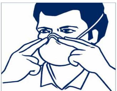
5. En utilisant les deux mains, presser la barrette nasale conformable autour du nez, pour assurer une parfaite étanchéité. Presser la barrette nasale conformable avec une seule main peut entraîner une étanchéité imparfaite. Les fuites ainsi provoquées peuvent réduire la protection que confère le masque.
