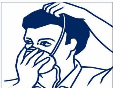
3. Placer le masque sous le menton, la barrette nasale en haut, l'appliquer sur le visage. Prendre la bande élastique supérieure et la ramener en haut derrière la tête.
