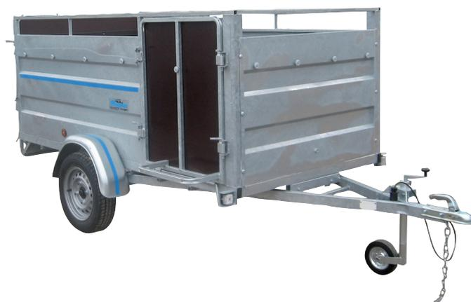
Polyvalente, elle est extrêmement robuste (châssis soudé, plancher contreplaqué marin anti-dérapant) et agréée pour le transport des animaux (plancher étanche avec bouchon de vidange, forme carrée pour augmenter la capacité de transport). Parfaitement étudiée pour tous les travaux et les besoins d'un élevage au quotidien ! Nécessite une carte grise spécifique
