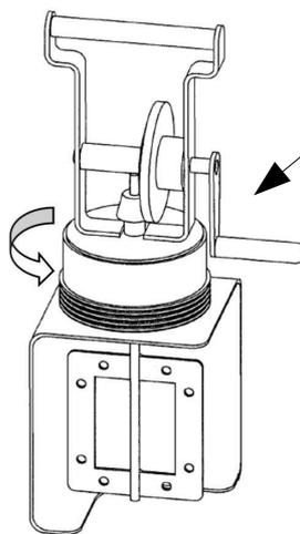
1) Dévisser la partie mécanique de l'appareil.
