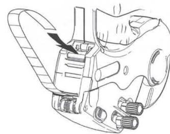
6. Tenez l'étiqueteuse tête en bas et face à vous. Pressez et maintenez la gâchette. En passant au-dessus du galet, introduisez la bande d'étiquettes dans la plus grande fente juste en-dessous des flèches. Maintenez la bande d'étiquettes en place et pressez sur la gâchette au moins 8 fois jusqu'à ce que le support papier sorte à l'arrière. Enlevez les étiquettes non utilisables.
