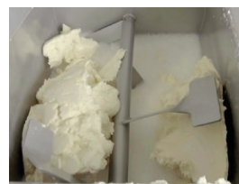
Vue en fin de barattage avant lavage du grain
