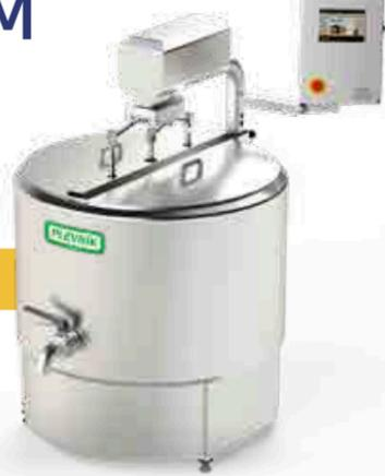
Une cuve de fabrication de fromage professionnelle, autonome et efficace pour les utilisateurs experts. Permet un chauffage plus rapide et dispose d'un système de pressurisation fermé (températures plus élevées) et de refroidissement indirect. Découpe automatiquement la masse de fromage (tranche-caillé automatisés). Positionnée sur un support stable avec un mécanisme d'inclinaison. Couvercle en inox pour la protection du moteur.
